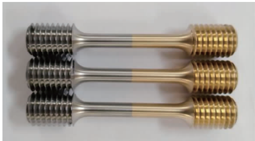
图1 结构钢/锡青铜拉伸试样
