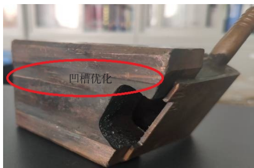
图2 水冷铜滑块设计优化
