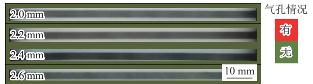
图 18 不同摆动幅度下单层焊道的探伤底片
