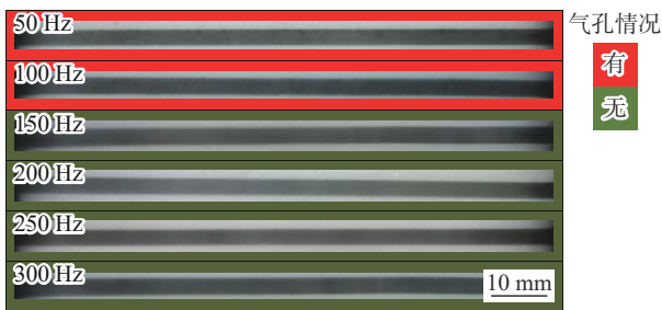
图 16 不同摆动频率下单层焊道的探伤底片
