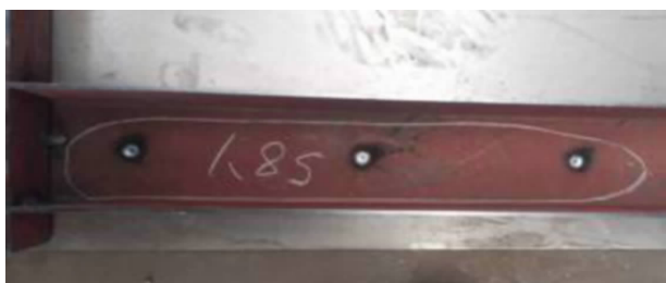
图 2 不同直径加工孔的电铆焊工艺试验典型试件照片
