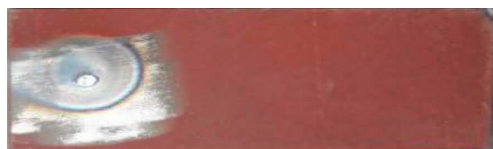
(b) 电铆焊试件(B面)
