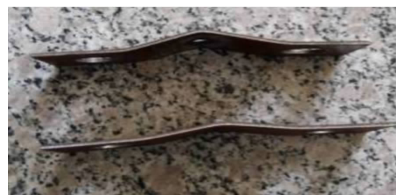
(b) 电铆焊试件(侧面)
