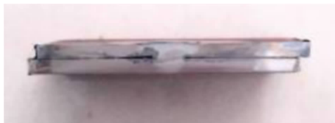
(a) 电钎焊试件(无脉冲)
