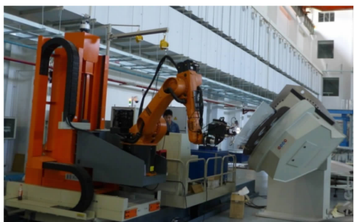
图5 多轴联动变极性等离子弧大型自动化焊接装备
