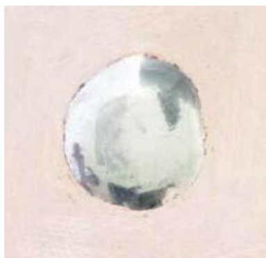
图 6 WOAs 质量分数为 4%、GA/PA 复配比例为 1:1 的焊点形貌
