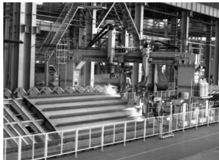
(b) 板肋单元机器人焊接系统
