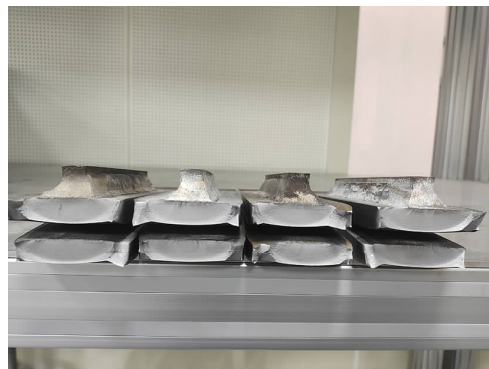
图6 疲劳断裂后的试件
