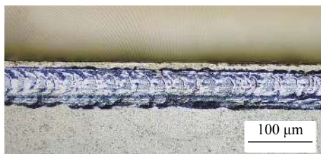
(b) 左侧鱼鳞状焊缝形貌
