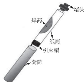
图 3 无电焊笔示意图<sup>[9]</sup>
