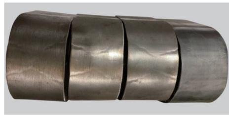
图4 弯曲试验后试样图
