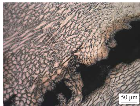
(b) B类合金 3 号试样显微组织(高倍)
