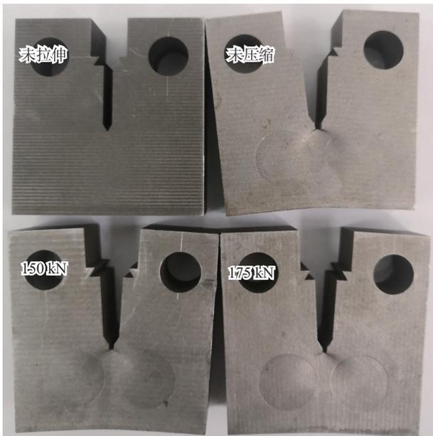
图3 断裂拉伸前后试样形态对比
