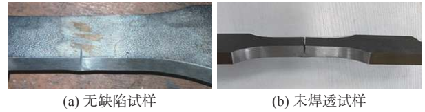
图8 疲劳试样失效示意图
