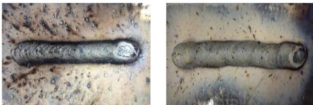
(a) 直流反接焊道飞溅情况 (b) 直流正接焊道飞溅情况
