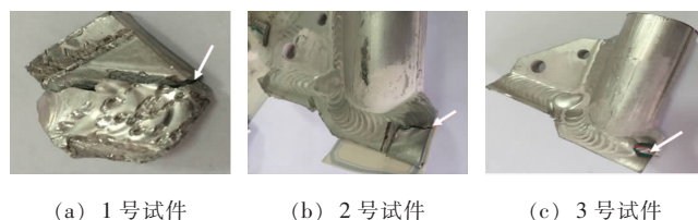
图2 上交叉管裂纹宏观形貌及分布位置
