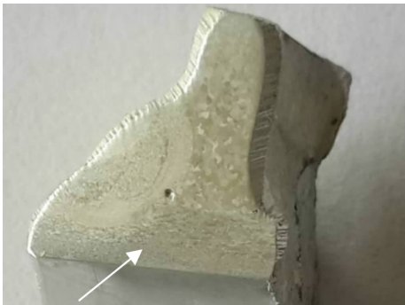
(a) 金相试样宏观照片(箭头所示为管端)
